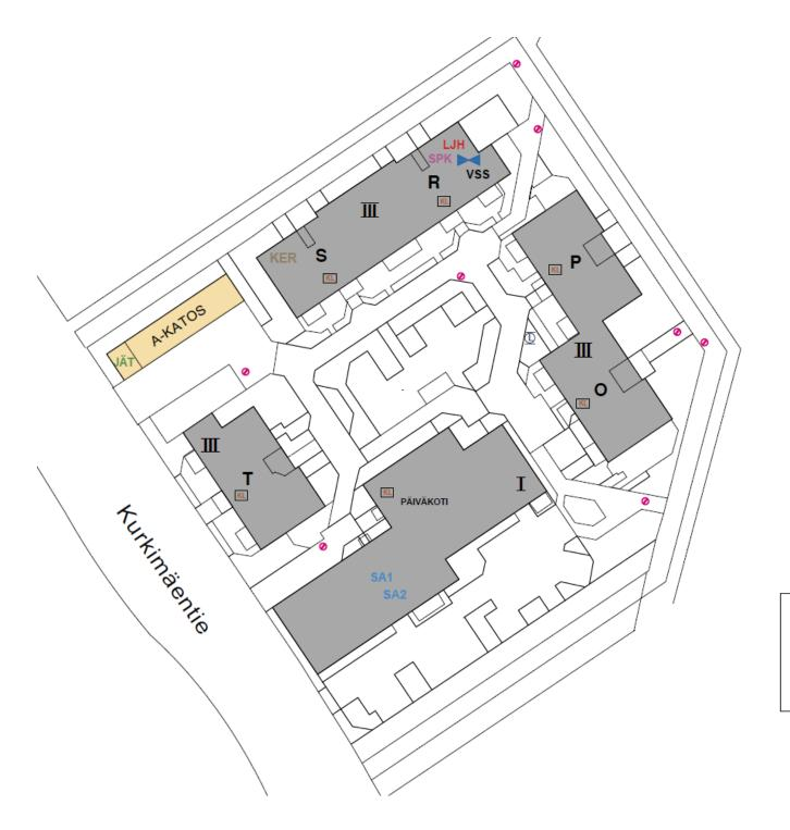
Lämmönjakohuone LJH Vesimittarit/pääsulku Sähköpääkeskus SPK SA Sauna Kerho **KER** VSS Väestösuoja JÄT Jätekatos 1 Lipputanko 0 Sadevesikaivo KL Kattoluukku
